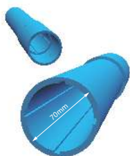
外径 Φ 70mm 圆形测斜管
